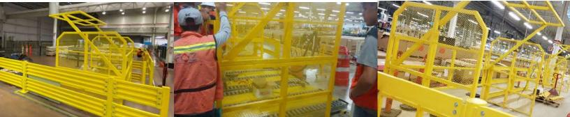
DISEÑO, FABRICACIÓN E INSTALACIÓN DE CAMA DE BOLAS PARA MANEJO DE MATERIALES.
